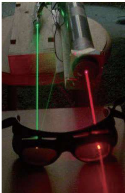
图 6-3 特定的眼镜只能防护特定激光演示图
